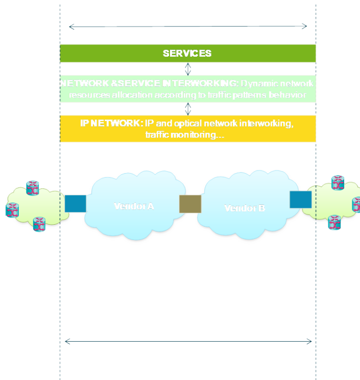
Rysunek 1: Ogólna architektura elastycznej sieci optycznej proponowanej w projekcie IDEALIST.
